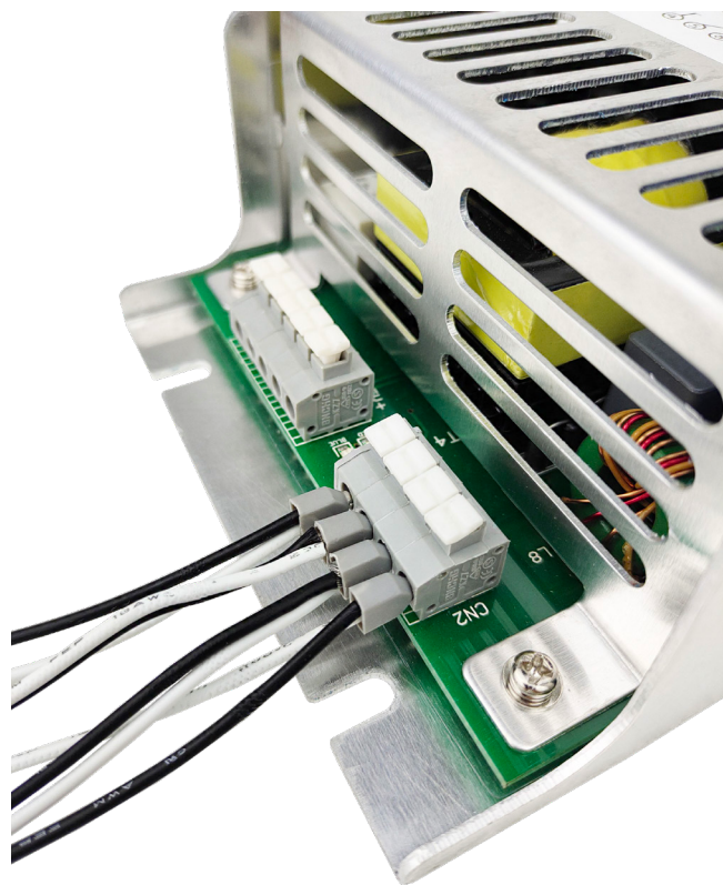
Рисунок 5. Подключение коннектора к ЭПРА
