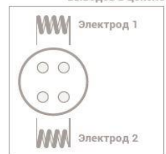
Схема соединения выводов в цоколе
