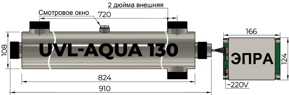
Рисунок 1. Габариты установки UVL-Аqua 130
