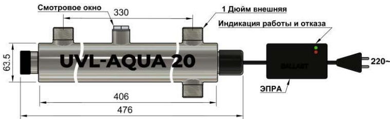
Рисунок 1. Габариты установки UVL-Aqua 20
