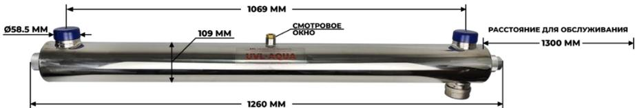
Рисунок 1. Габариты установки UVL-Aqua 245
