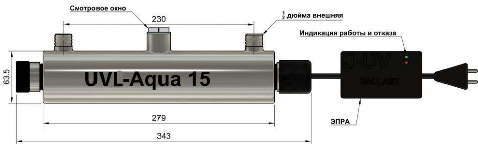
Рисунок 1. Габариты установки UVL-Aqua Hot 15
